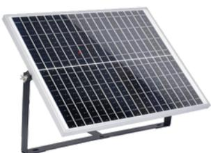
Dans le cas d'une VIGIBOX solaire, il sera nécessaire d'utiliser les 2 équerres fournies pour fixer solidement le panneau solaire de 50 watts, à moins de 2 m de la Vigibox, optimiser le positionnement du panneau solaire, éviter les zones d'ombres ( sous toitures...) et raccorder les connecteurs solaires fournis à la vigibox.
